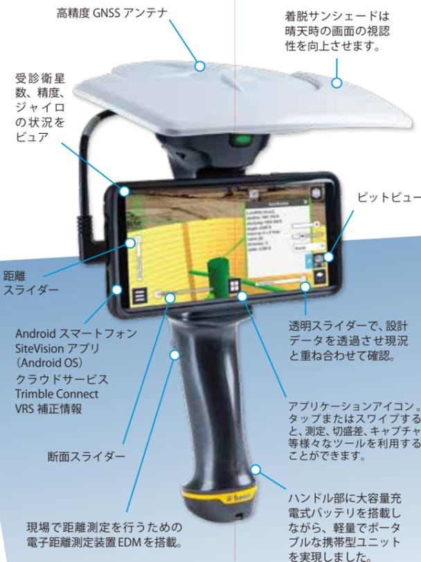
高精度 GNSS アンテナ
