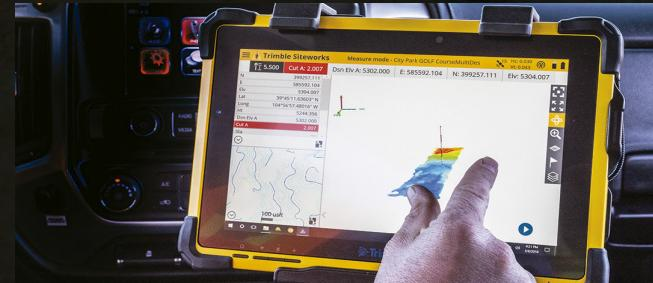
Trimble Siteworks Positioning System for Supervisors は、SPS986 または SPS785 GNSS スマートアンテナ、TSC7 コントローラ及び Siteworks ソフトウェアで構成されます。建設現場監督の皆様にお使いいただくと、ノート型パソコンを持ち歩かずに、現場にて各種オフィスソフトウェアパッケージを実行し、データや 3D モデルの処理作業を簡単に行うことができます。
